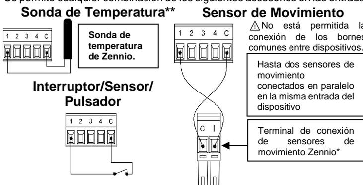
\* En el caso del sensor ZN110-DETEC-P, colocar su micro interruptor 2 en **posición Type B**.
