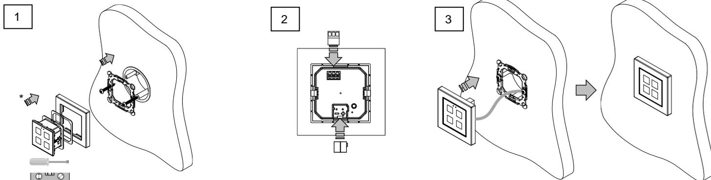
\* (Opcional) Intercalar la/s chapa/s niveladora/s metálica/s para conseguir que el dispositivo quede a la profundidad deseada.
