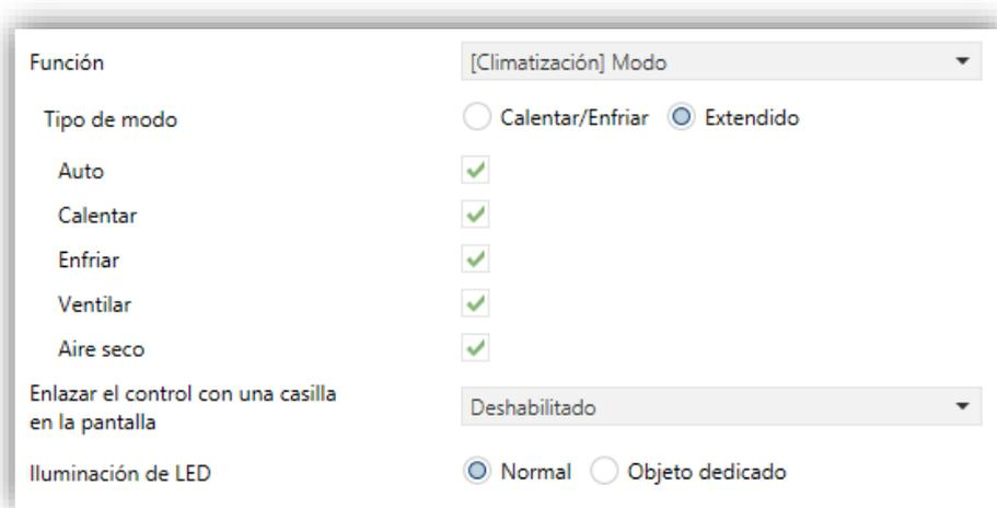
Figura 29. Pulsador individual – [Climatización] Modo (Extendido).
