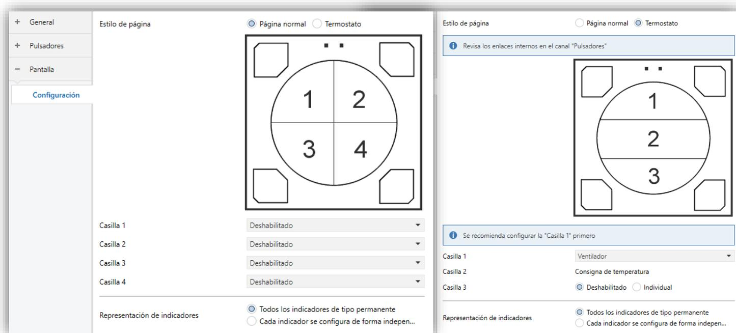
Figura 47. Pantalla – Configuración - Página normal / termostato.
