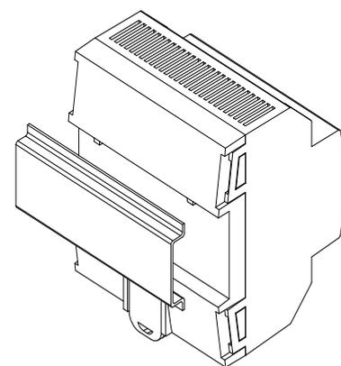
Figura 3: Montaje de NarrowDIM X4 en carril DIN
