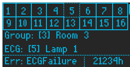
Figura 53. Ejemplo de fallo de balasto
