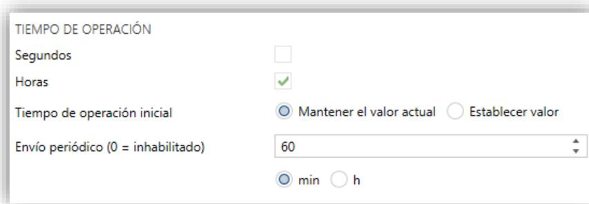
Figura 12. Pasarela A/A. Configuración. Tiempo de operación.
