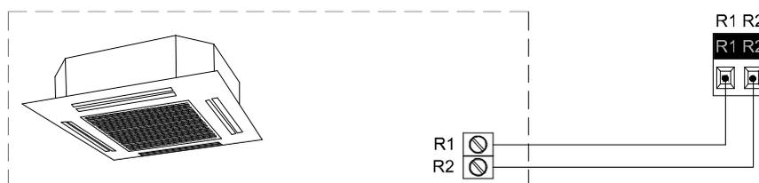
Figura 2. Conexión del KLIC-PA a la máquina de A/A.
