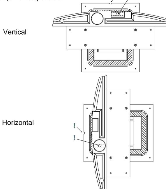
**5** Fijar el accesorio a las guías de la pared mediante los tornillos adecuados (no incluidos) [1]. Una vez fijado, puede retirarse la *pieza auxiliar de montaje* con sus cuatro tornillos [2].
