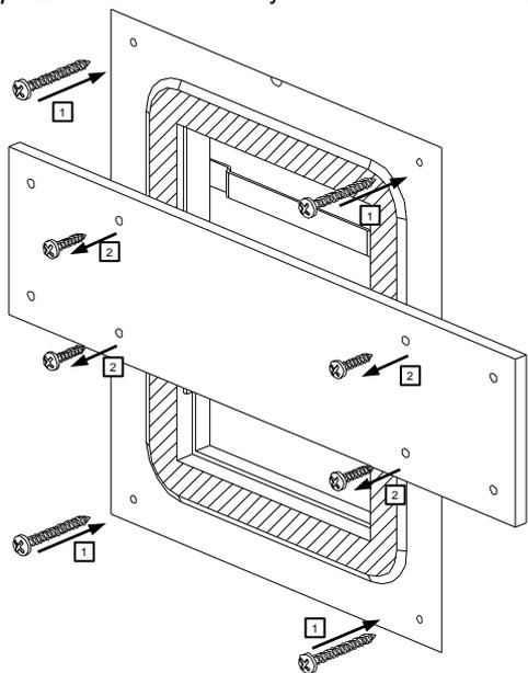
**6** Realizar los trabajos de emplastado evitando la *superficie enrasada*. Una vez seco se pueden realizar los trabajos de pintura y acabado de la pared (evitando pintar la *parte interior del accesorio*)
