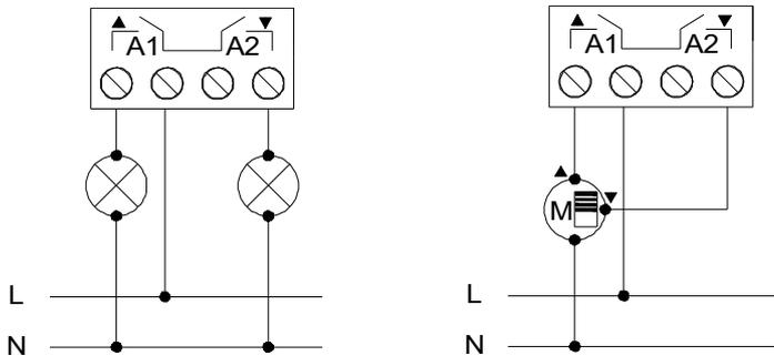
⚠ Para asegurar el estado esperado de los relés, antes de alimentar el circuito de potencia debe conectarse el bus KNX al dispositivo.
