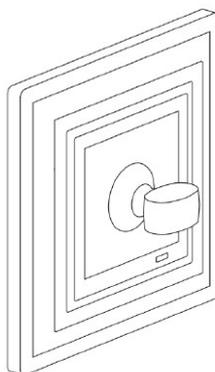
El aparato se puede extraer del aro metálico tirando de él por la parte del marco. Para facilitar esta tarea existe una ventosa, con referencia: W-HEBER. No incluida en el embalaje. Especialmente indicada para extraer el LS Touch si ha sido instalado con el sistema de montaje LS Zero.
