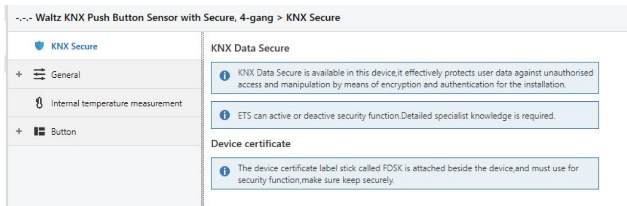
Fig.5.1 (1) "KNX Secure" parameter window
