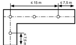
En salas contiguas y pasillos, coloque el primer sensor a una distancia máxima de 7,50 m respecto al extremo de la sala. Distribuya al menos tres sensores en 15 m. Coloque sensores en el centro de las esquinas y las intersecciones de los pasillos.
