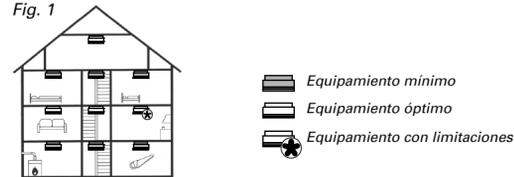
Como protección mínima se deben instalar detectores de humo en los dormitorios y los pasillos para poderse despertar en caso de dispararse una alarma de humo. En los edificios con varias plantas, además, se debe instalar al menos un detector de humo por planta en el pasillo. Para obtener más directivas de instalación extraiga información de DIN 14676.
