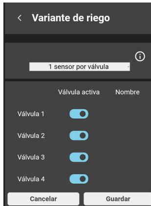
Además, las válvulas se pueden activar y desactivar. ¡La válvula desactivada no aparecerá en el menú de operación y no se efectuará el riego!
